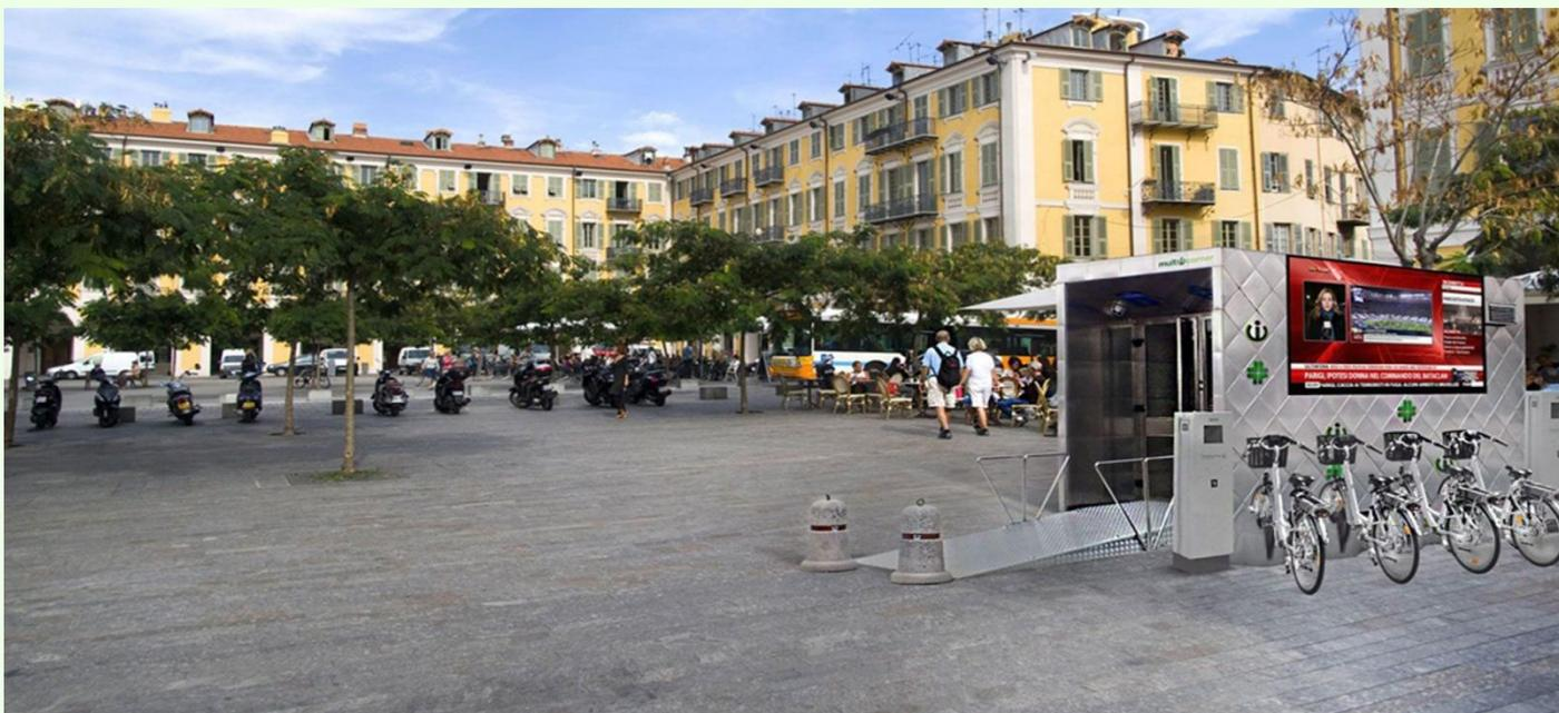
Dall'esterno lo sportello appare come un parallelepipedo in acciaio INOX AISI 304, a placche romboidali alternate a pannelli fotovoltaici della stessa forma, che donano movimento e colore alla struttura.
